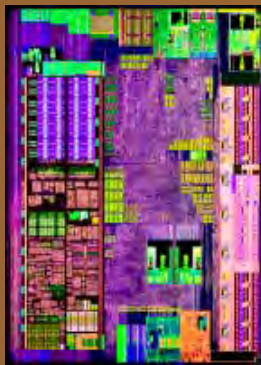
Intel® Atom™ N450 (‘Pinetrail’) processor die
