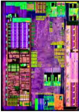
Intel® Atom™ N450 ('Pinetrail') processor die
